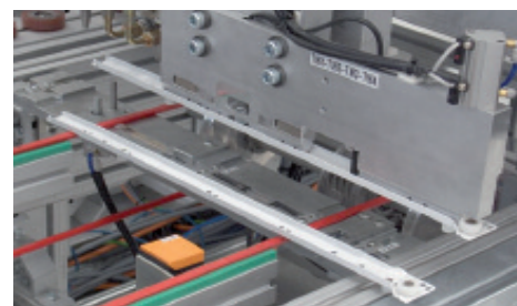
Insertion de glissières de tiroirs.
